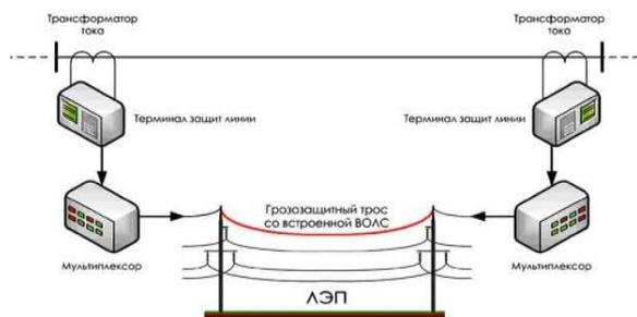
Рис. 10. Применение ВОЛС в продольных дифференциальных защитах линий
