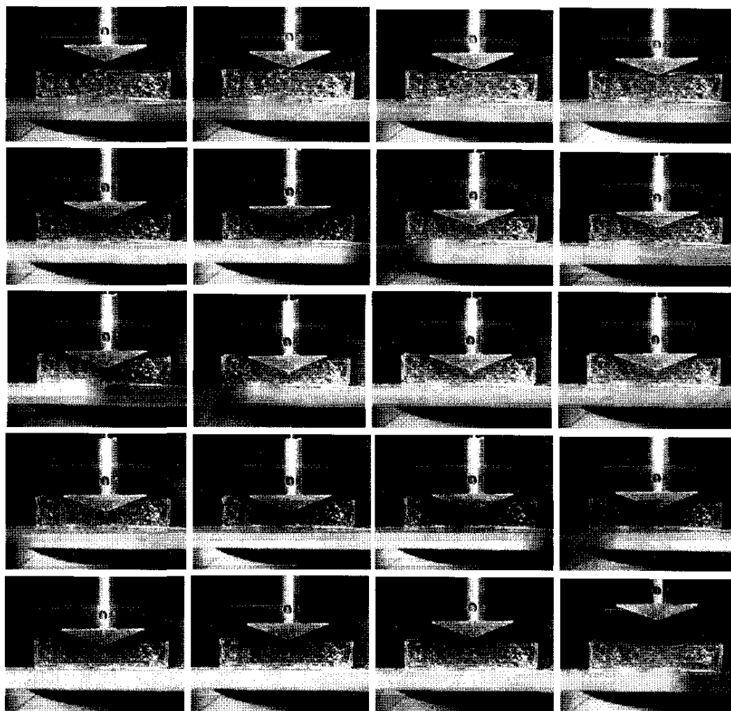
Рис. 5. Упругое деформирование при последовательном нагружении и разгрузении композита металлическое основание – клей на основе натурального каучука – металлическое покрытие.
