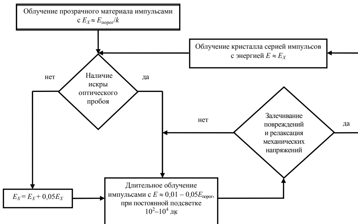
Рис. 1. Технологическая схема лазерной обработки прозрачного кристалла с целью повышения оптической прочности, в зависимости от оптических характеристик материала коэффициент k = 2\text{--}20
