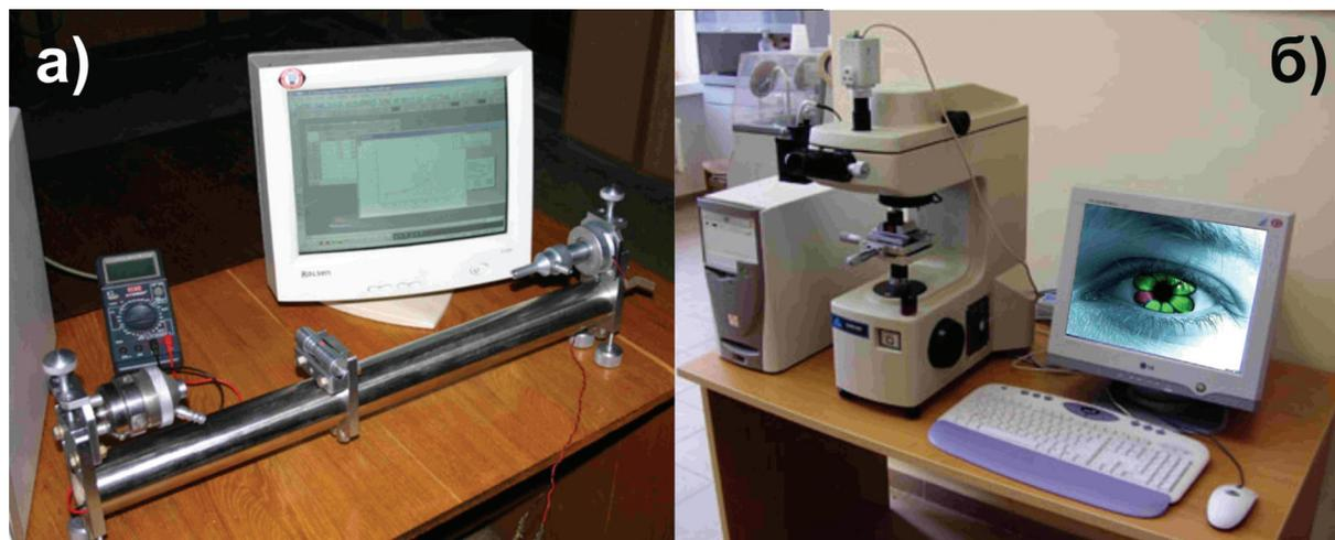
**Рис. 5.** Лазерный измеритель линейных размеров (а), комплекс технического зрения (б)
