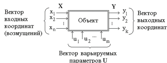
Рис. 2.11. Схема представления объекта для разработки ИНС-модели
