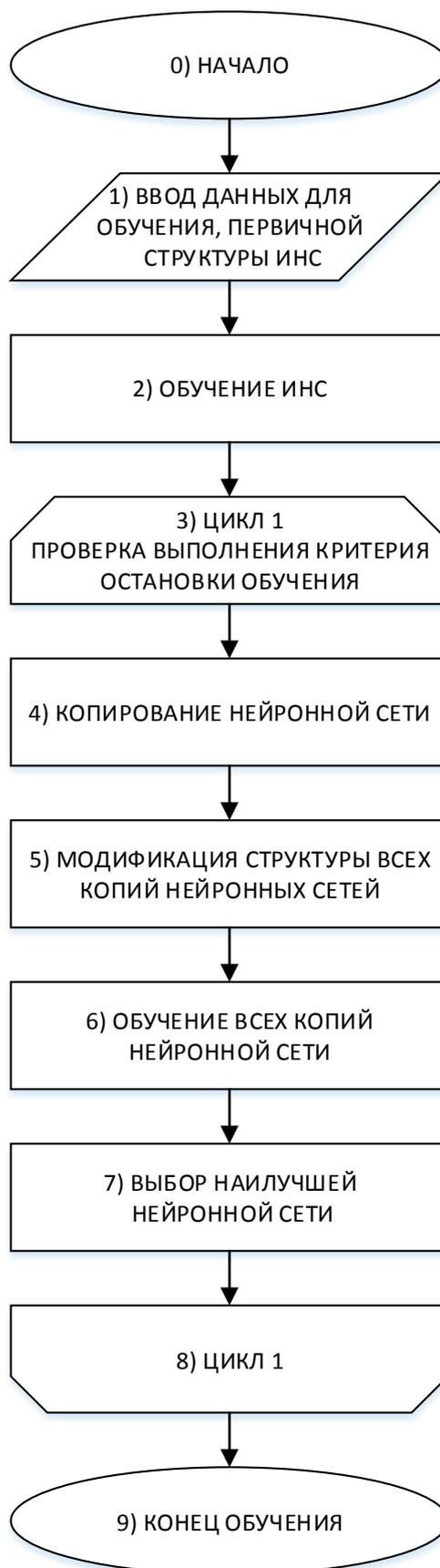
Рис. 1. Алгоритм адаптации структуры нейронной сети
