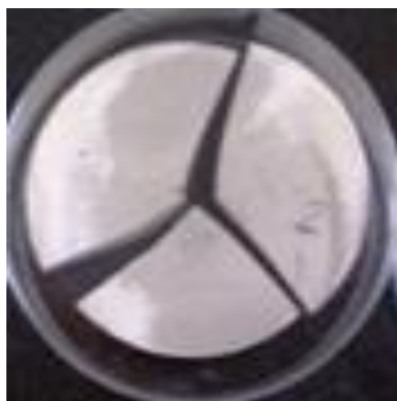
Рис. 3. Разрушенный образец после испытаний на двусное сжатие методом шара на трех шарах
