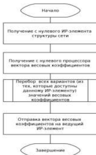
Рис. 2. Блок-схема информационного процесса обучения, запущенного на неведущем (неуправляющем) ИР-элементе при использовании метода полного сканирования
